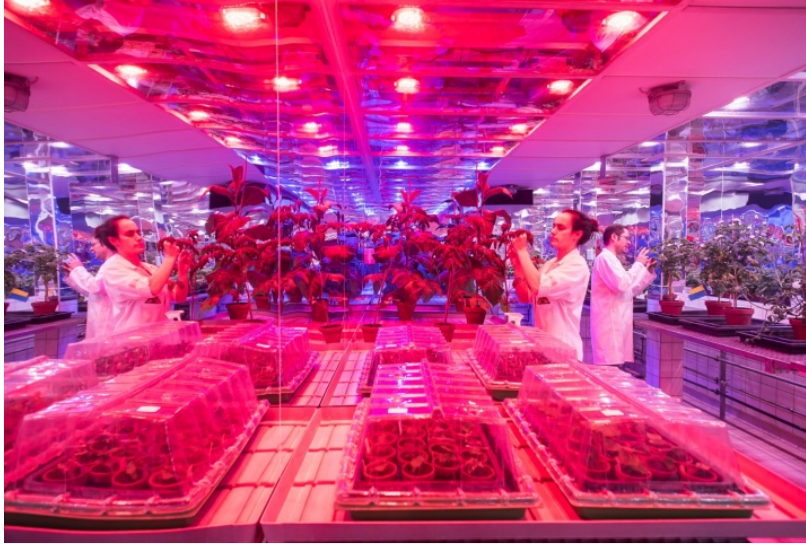
Die LEDs emittieren Licht einer definierten Wellenlänge. Foto: Kovalenko
